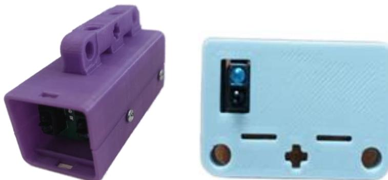
Рисунок 9. Датчик линии
