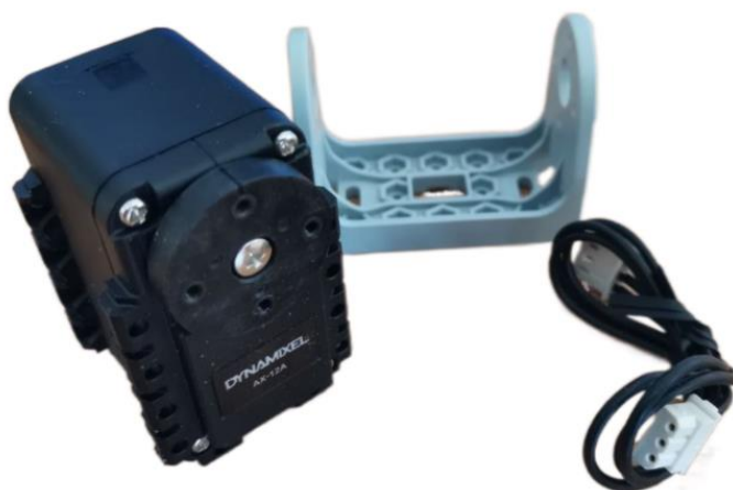
Рисунок 3-3 Сервомодуль DYNAMIXEL AX-12A
