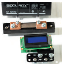
Крепление шунта и амперметра-вольтметра
