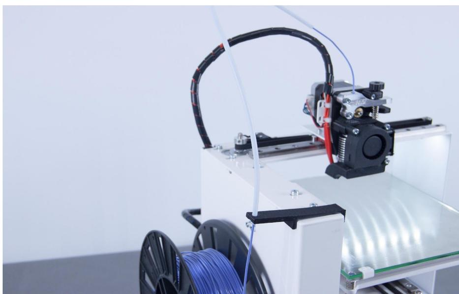
Протяните пластик через трубку и вставьте пруток в отверстие сверху экструдера.
