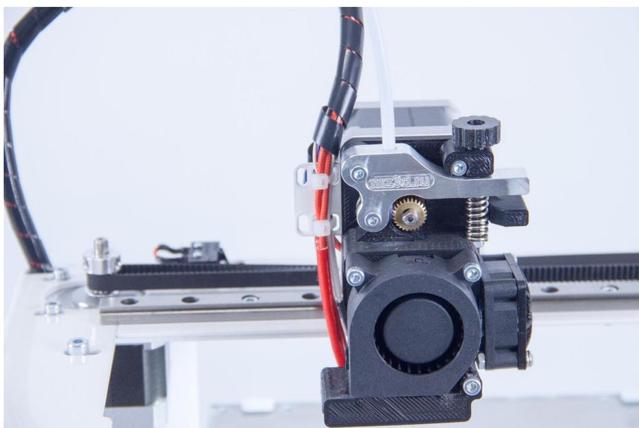
Правильно вставленный пруток проходит между подающей шестерней и прижимным роликом.
