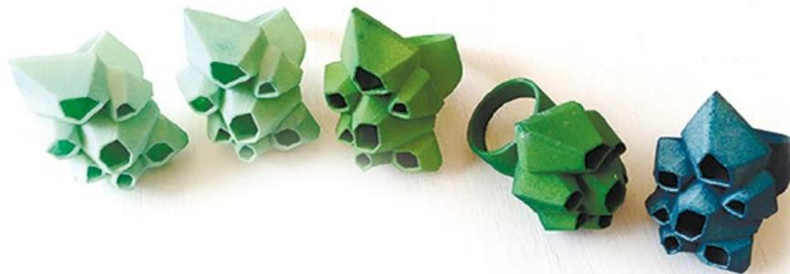
При изготовлении ювелирных изделий самой трудоёмкой процедурой является создание восковых моделей. Технология, основанная на использовании 3D-принтера, позволяет быстро создавать восковые модели украшений, разработанные в специальной программе 3D-дизайна.
